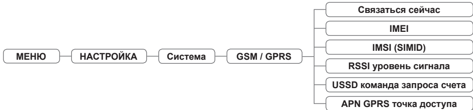
Рисунок 24. Структура подменю «GSM/GPRS» контроллера ОС6000
