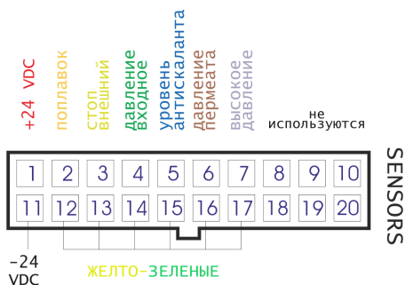
Рисунок 2. Входы ОС6000 — разъем дискретных входов SENSORS
