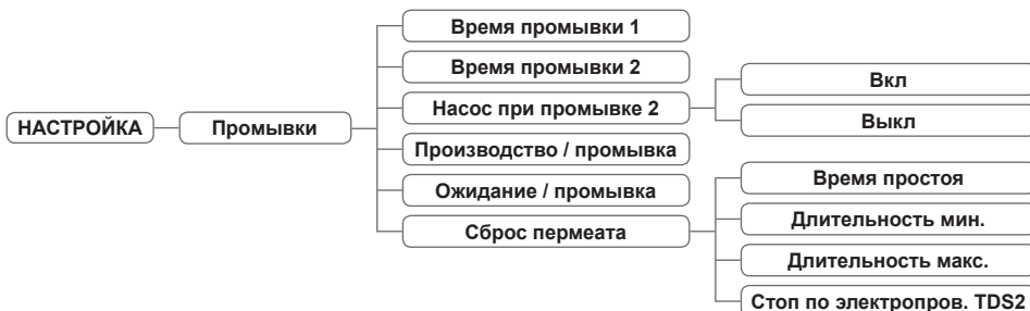
Рисунок 18. Структура подменю «Промывки» контроллера ОС6000
