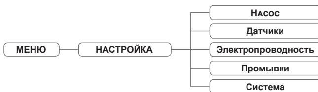
Рисунок 14. Структура подменю «НАСТРОЙКА» контроллера ОС6000
