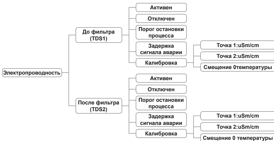
Рисунок 17. Структура раздела «Электропроводность» меню контроллера ОС6000
