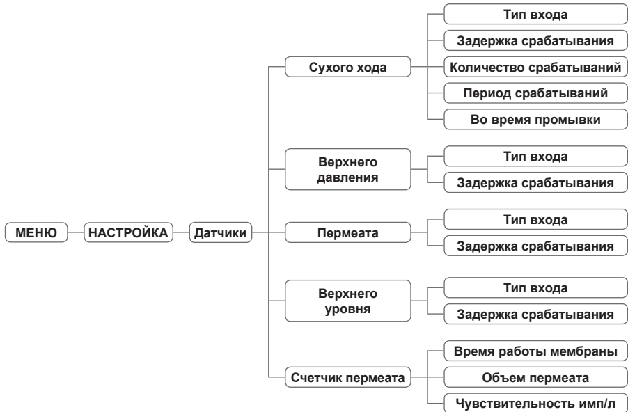
Рисунок 16. Структура раздела “Датчики” меню контроллера ОС6000
