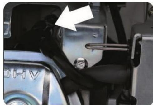
Свеча зажигания: эквивалент TORCH F6TC.
