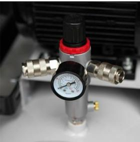
Зачастую, используемый пневмоинструмент требует меньшего давления. В таких случаях рекомендуется выставлять требуемое давление при помощи регулятора, что позволяет снизить нагрузку на компрессор и соответственно увеличивает его ресурс. На компрессорах Matarí оснащенных регулятором давления, можно выставить необходимое рабочее давление.
