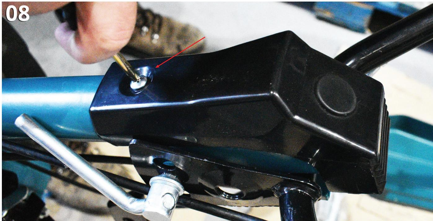
Мал.9. Закріплюємо крило на культиватор за допомогою болтів та гайок.
