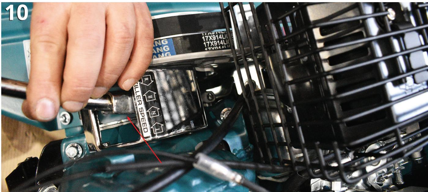
Мал.11. Кріпимо подовжувач ручки коробки передач за допомогою стопорного пальця, який фіксуємо шплінтом.
