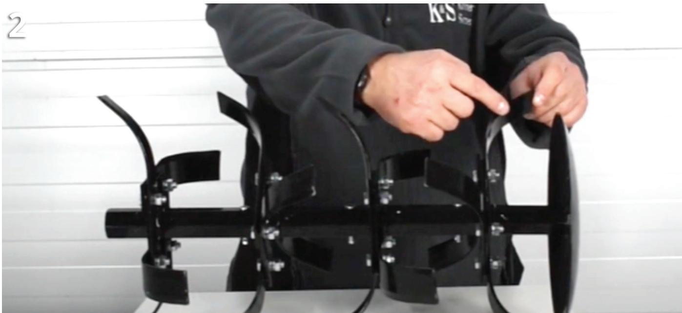
Мал.3. Збираємо ліві фрези культиватора. Ліві ножі ріжучою поверхнею від користувача повернуті наліво, праві ножі - ріжучою поверхнею від користувача повернуті направо.
