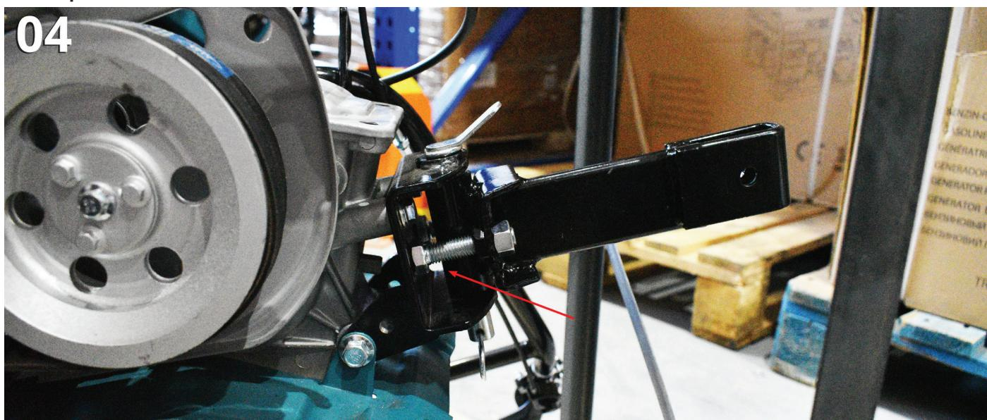
Мал.5. Встановлення транспортального колеса на раму культиватора. Кріпимо колесо за допомогою стопорного пальця та шплінта.
