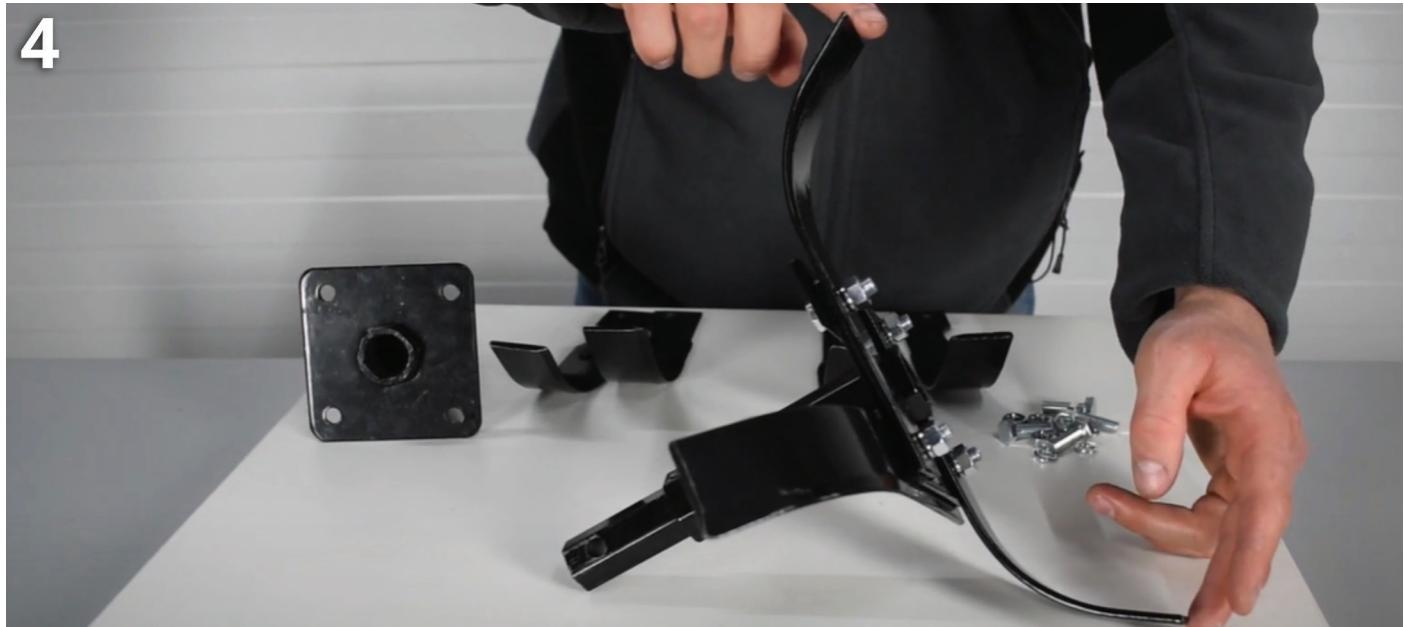
Мал.5. Кріпимо 2 правих ножі з внутрішньої сторони основи вигинами вправо один навпроти одного. Ріжуча поверхня всіх ножів має бути розташована попереду - за напрямком руху культиватора.
