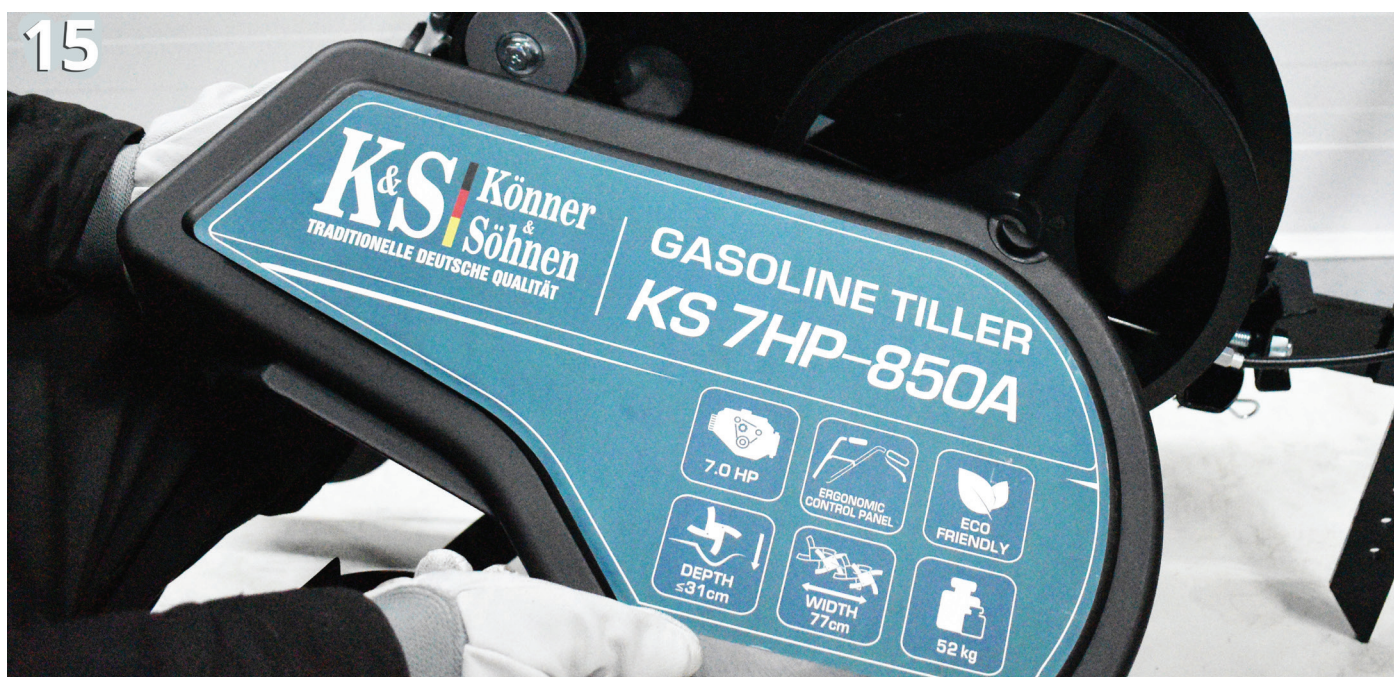
Мал.15. Встановлення захисного кожуха на корпус культиватора.
